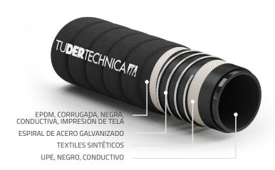
Manguera de succión y suministro diseñada para cumplir con la norma EN12115 adecuada para productos químicos. Manguera probada y certificada por BUREAU VERITAS para ser utilizada en el area ATEX (Ex-Zone).
